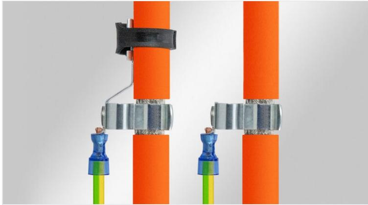
Die EMV Schirmklammern sind auch auf Ringkabelschuhen erhältlich. Diese Schirmklammern ermöglichen eine sichere und einfache Abschirmung von Leitungen. Auch an schwer zugänglichen Stellen kann so der Kabelschirm mit dem Massepotential verbunden werden. Die PE Leiterlänge wird kundenseitig festgelegt und mit dem Ringkabelschuh verquetscht.
